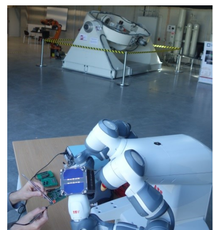
Zusammenarbeit von Mensch und Roboter bei der Integration der Satelliten. Die Anlage zur Simulation der Dynamiktests im Hintergrund.
